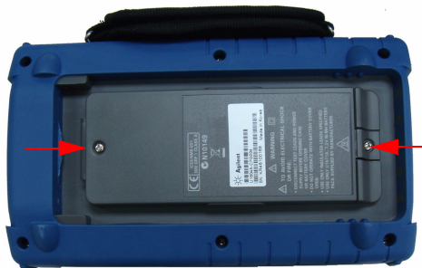
図8-3 バッテリー・カバーのネジを外す
