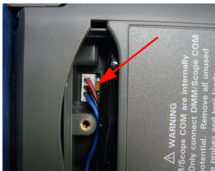
図8-6 ピンセットを使って3端子コネクタを引き抜く
