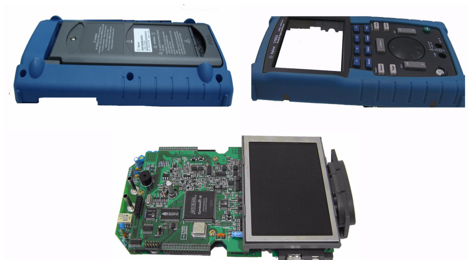
図8-10 フロント・カバー(右)とリア・カバー(左)を測定器のプリント基板から取り外す
