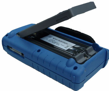
図8-5 スタンドを取り外さずにバッテリー・パック・カバーを取り外す
